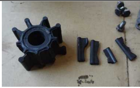
写真3 破損した冷却海水ポンプのゴム製のインペラ
