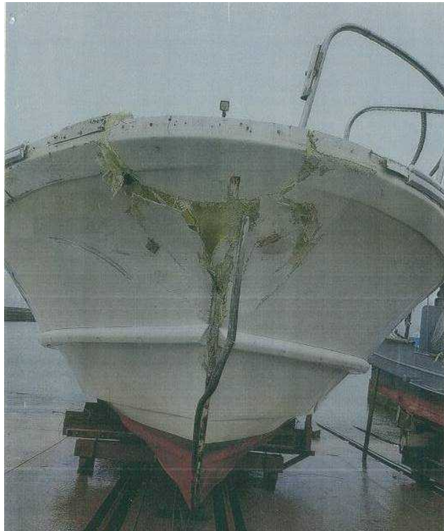
写真2 本船の損傷状況（船首部）
