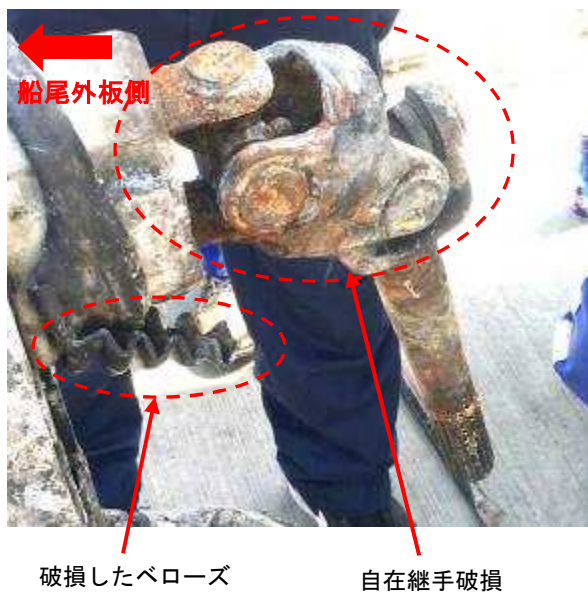
写真2 ベローズ及び自在継手の破損等状況
