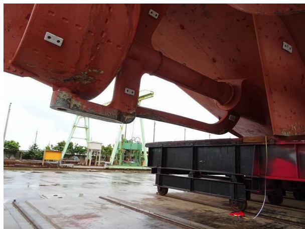
写真3 A船コルトノズル下部損傷状況
