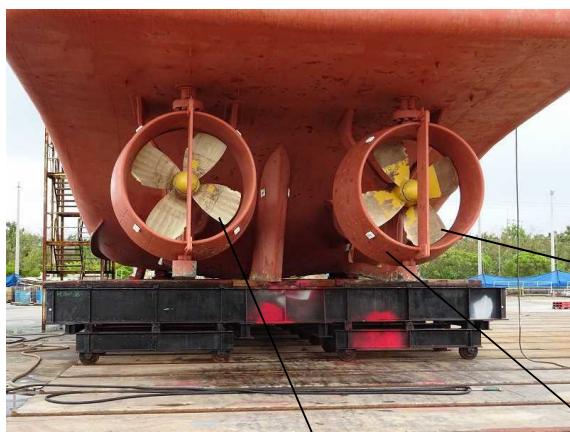
写真1 A船プロペラ翼損傷状況
