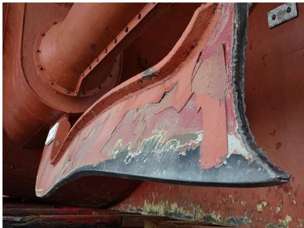
写真2 A船シューピース損傷状況
