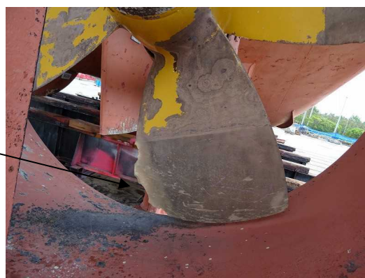
右舷機プロペラ翼損傷
