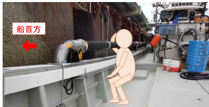
写真1 甲板員Aの右腕が巻き込まれた状況 (イメージ)
