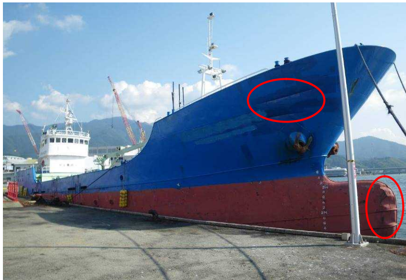
写真3 C船の損傷状況
