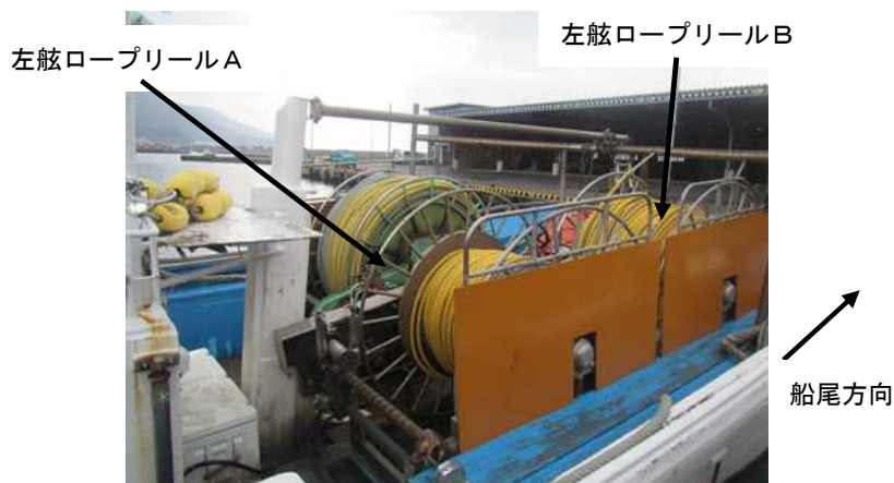
写真1 後部甲板に設置されたロープリール
