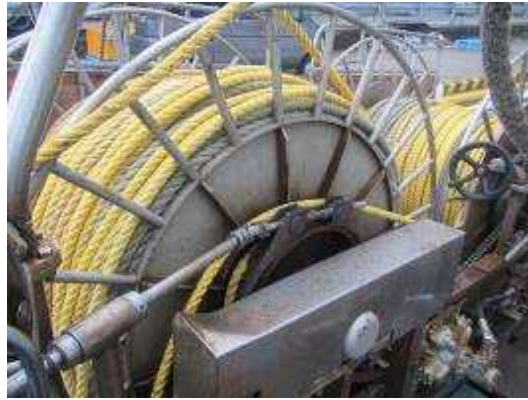
写真2 左舷ロープリールBの外枠から外れた引綱
