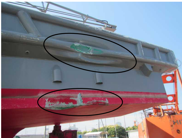
写真2 B船の損傷状況（左舷船尾部外板）
