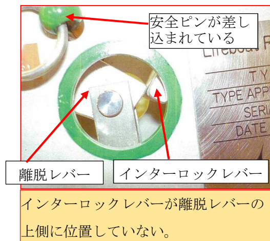
写真12 インターロックが不完全なロック状態
