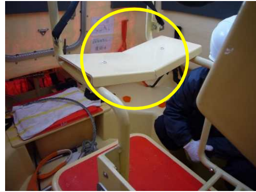
写真4 操縦席座面の折損状況
