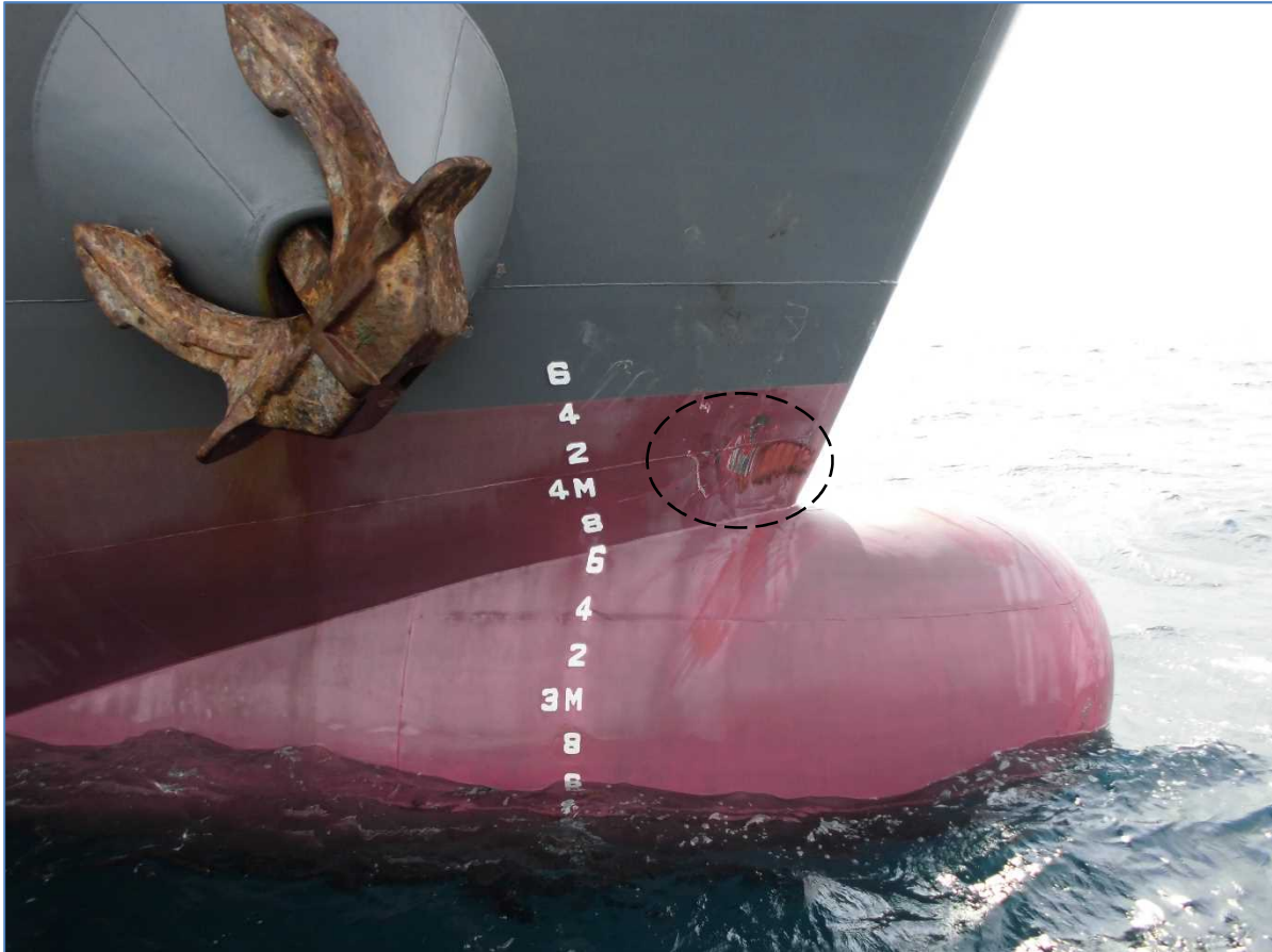
写真1 B船の損傷状況（右舷船首部）
