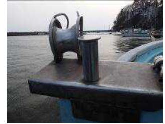
写真4 左舷船首部舷縁に設置されたローラ
