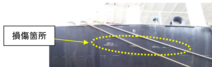
写真4 A船の右舷後部外板の損傷状況
