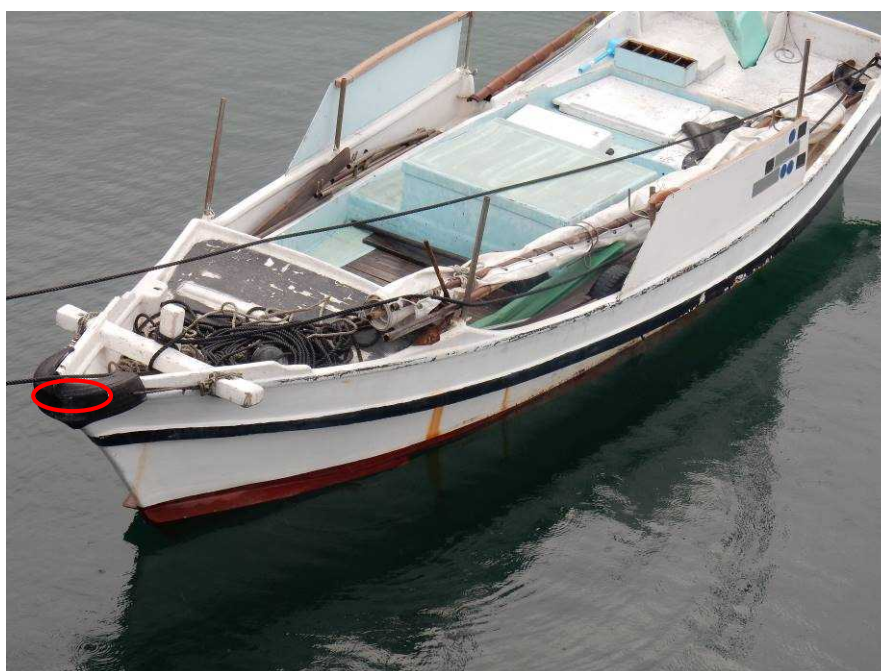
写真2 B船の損傷状況（左舷船首部）
