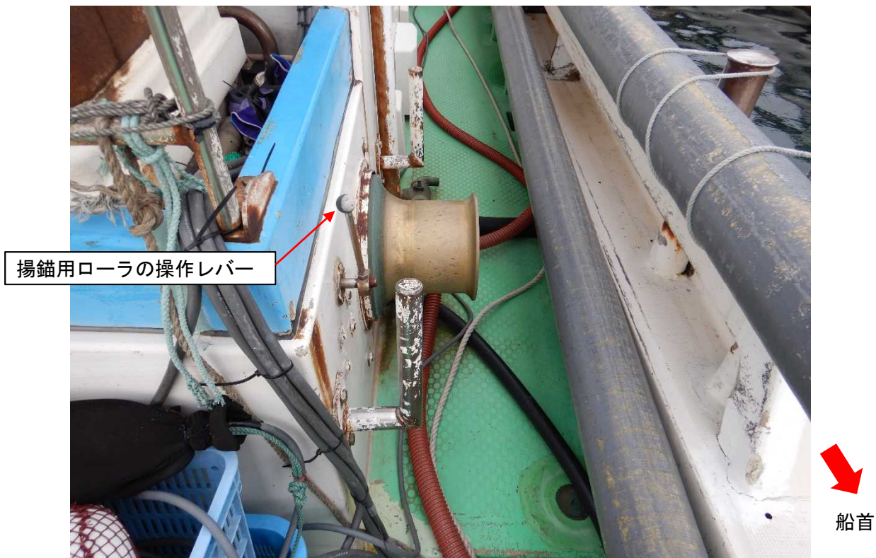
写真4 船長が揚錨用ローラに右足を巻き込まれた直後の状況（再現）
