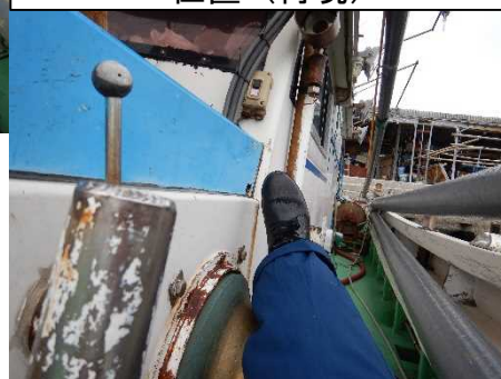
写真5 揚錨用ローラに巻き込まれた際の右足の位置（再現）
