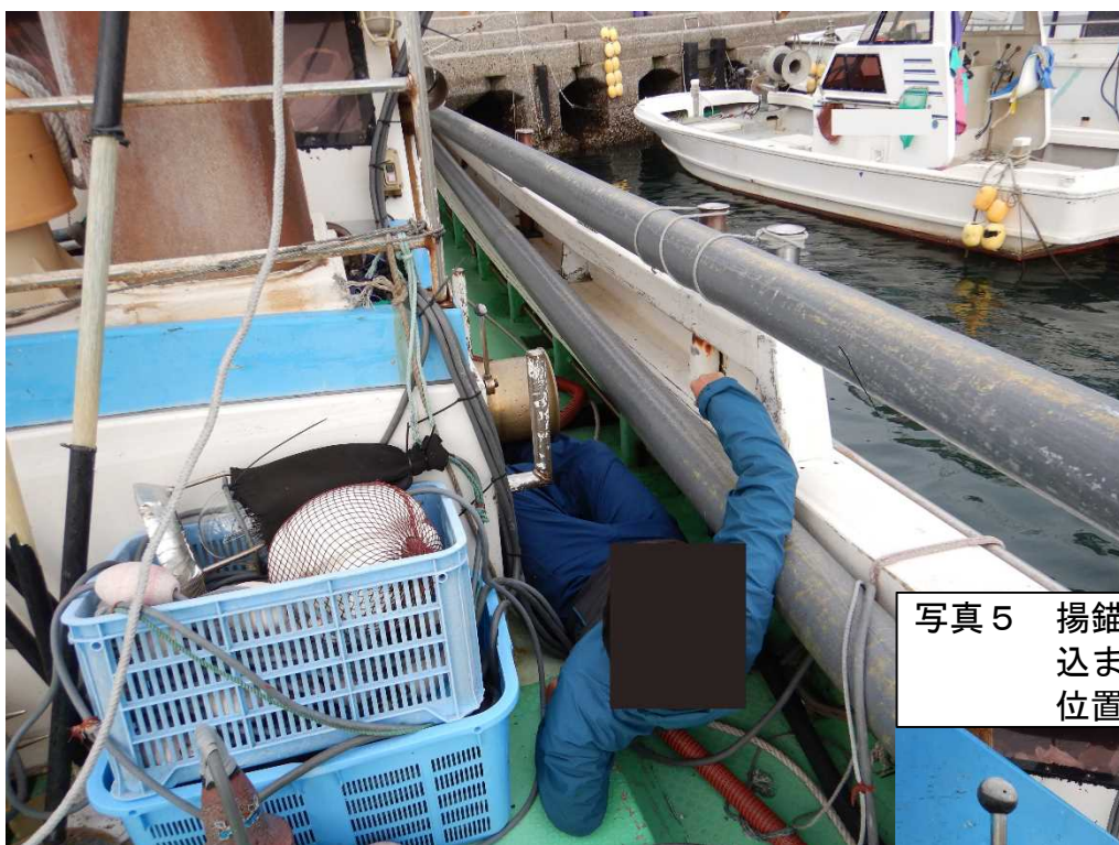
写真4 船長が揚錨用ローラに右足を巻き込まれた直後の状況（再現）
