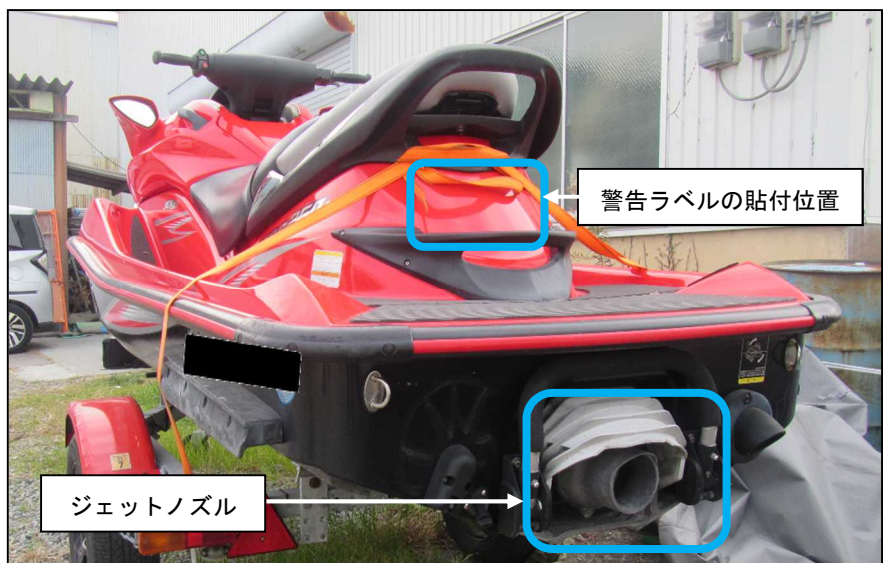
写真2 ジェットノズル及び警告ラベルの貼付位置
