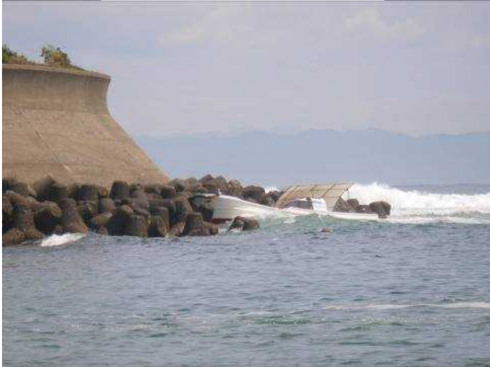
写真1 本船の本事故後の乗揚状況
