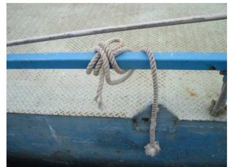
写真8 破断した係留索 (ドーム船にもやった状況（再現）)
