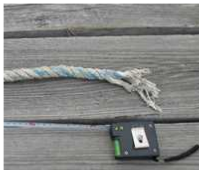
写真7 破断した係留索 (手摺りの青色塗料が付着)
