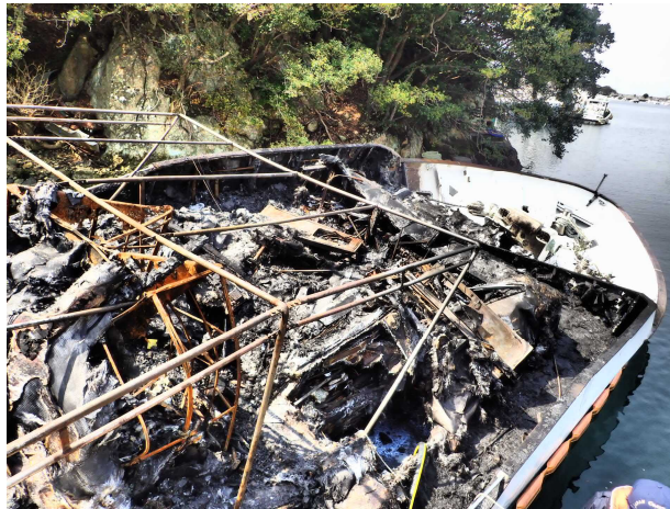
写真1 本船の焼損状況（船首部）
