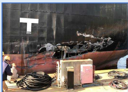
左舷船側外板の破口及び凹損
