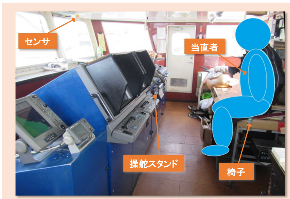
写真4 当直者とセンサの位置 (B船船橋)
