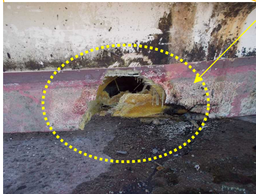
写真4 B船左舷船底部損傷状況
