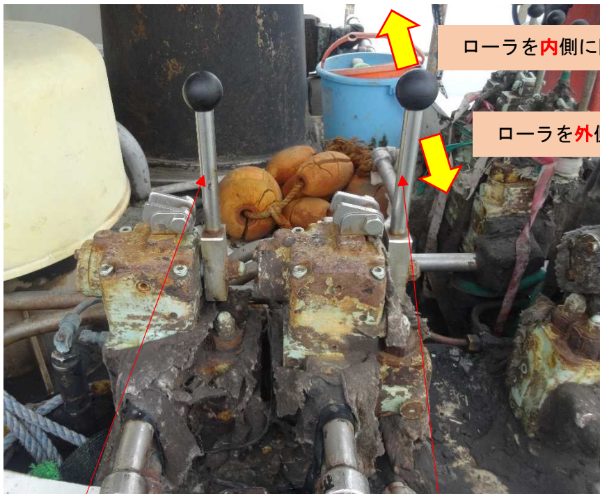
写真6 サイドローラ操作レバーの状況②
