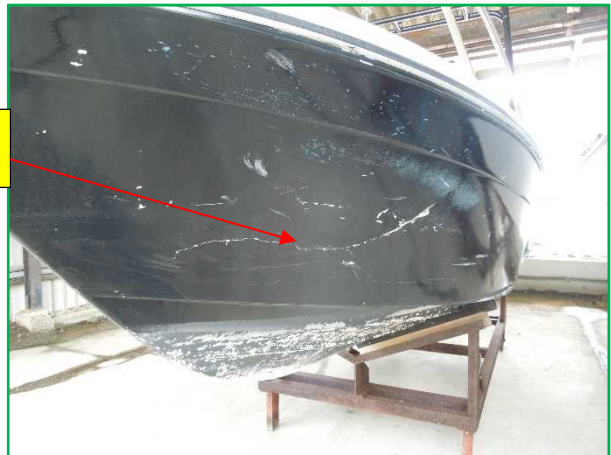
写真2-2 A船の損傷（左舷船首部）
