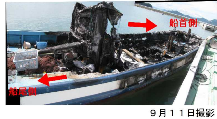
写真2 焼損状況 (右舷船尾方から撮影)
