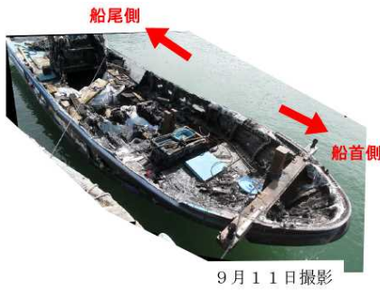
写真1 焼損状況 (甲板上全景)
