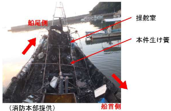
写真3 焼損状況 (船首部から撮影)
