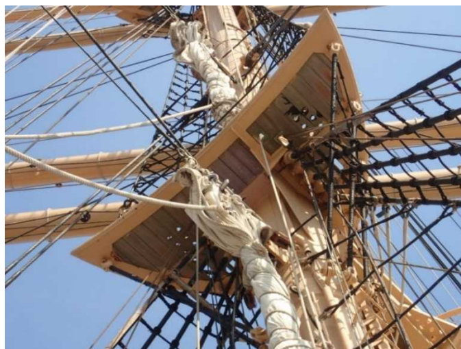
写真 2.5-2 トップボードを貫通する索の状況
