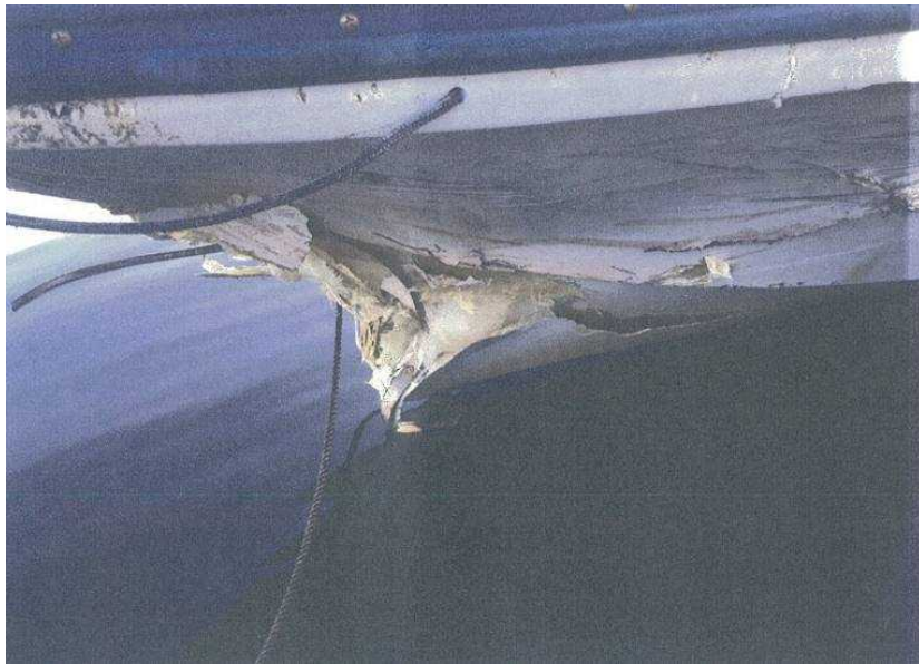
写真3 船首部の損傷状況
