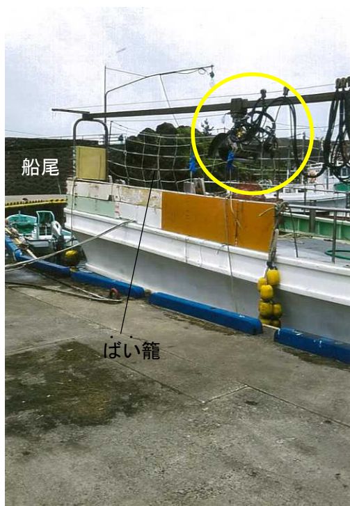
写真2 ボールローラの設置状況
