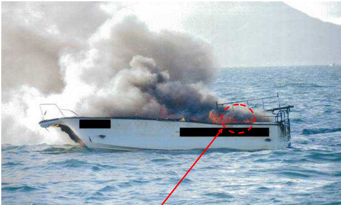
本件発電機が設置されていた場所
