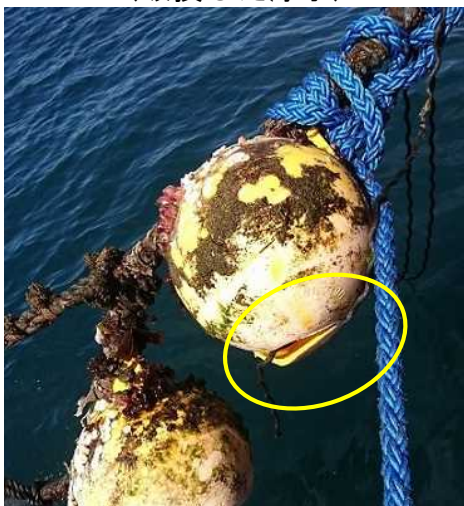
写真5 本件定置網の損傷状況 （破損した浮子）
