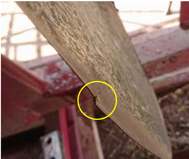
写真2 A船の損傷状況（プロペラ翼の欠損）
