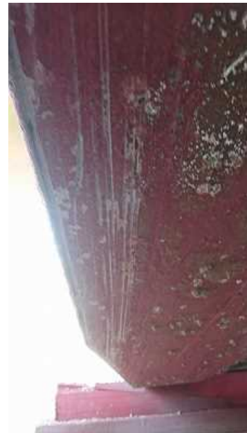
写真3 A船の損傷状況 （船底の擦過傷）
