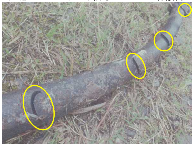
写真6 本件定置網の損傷状況 （A船のプロペラに破損されたワイヤ保護筒）
