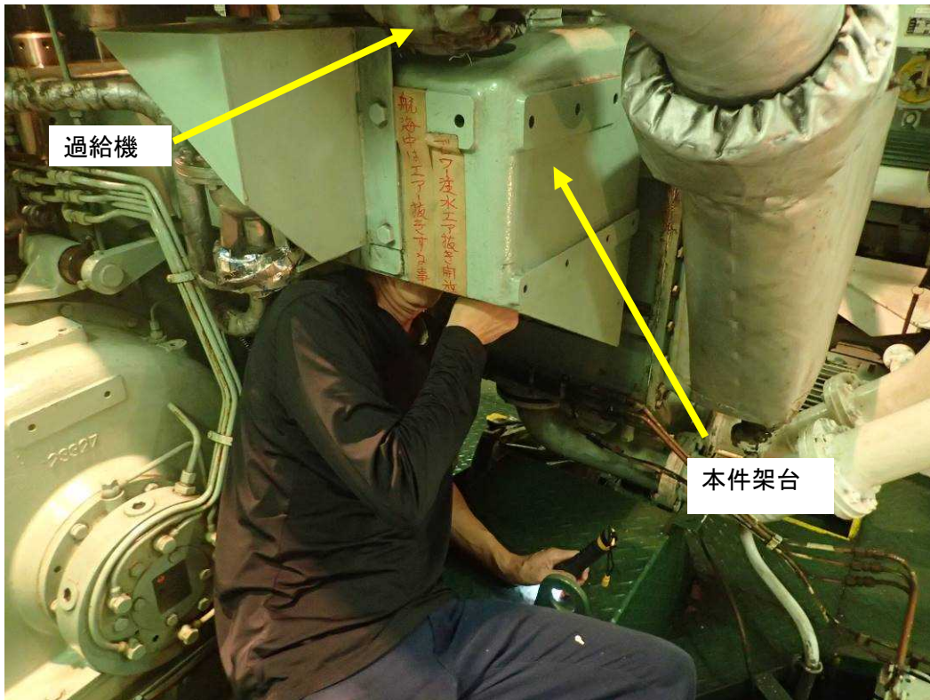
写真4 溶接作業中の機関長の姿勢
