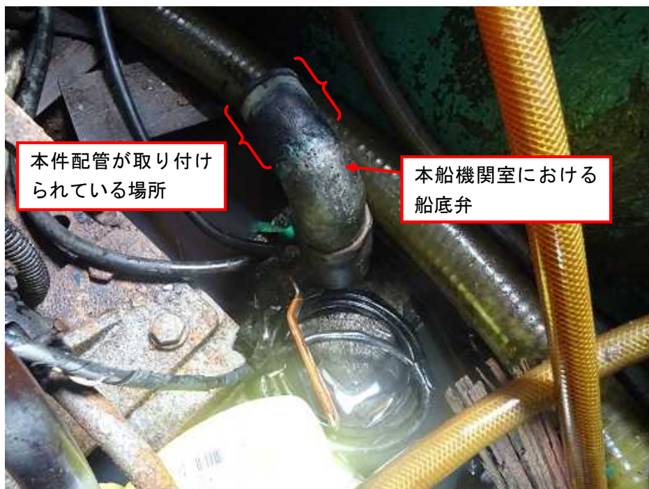
写真1 本船機関室における船底弁
