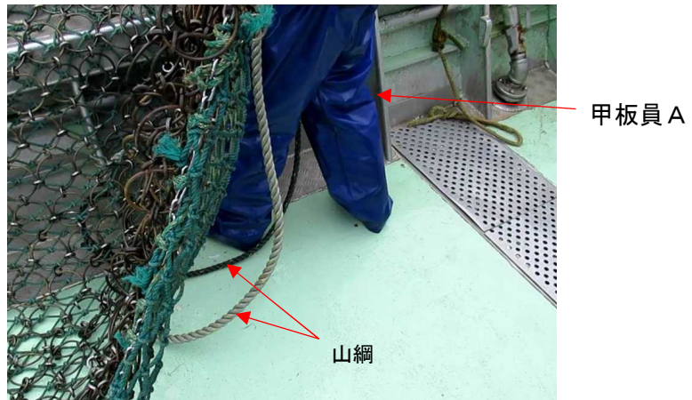
写真6 左足に山網が絡まる直前の状況（想定）
