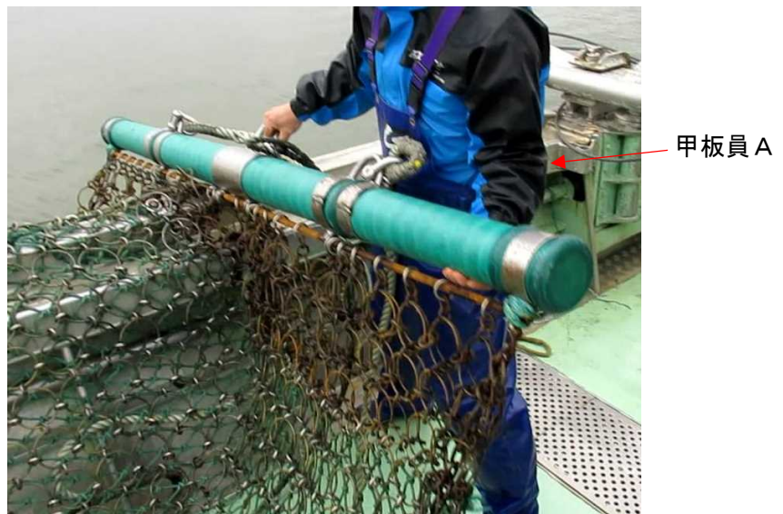
写真4 尻棒投入時の状況(再現)
