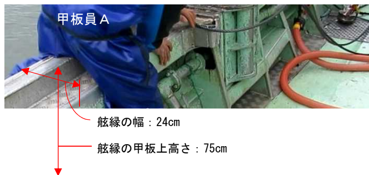
写真7 甲板員 A が右舷舷縁を跨いだ状況（再現）
