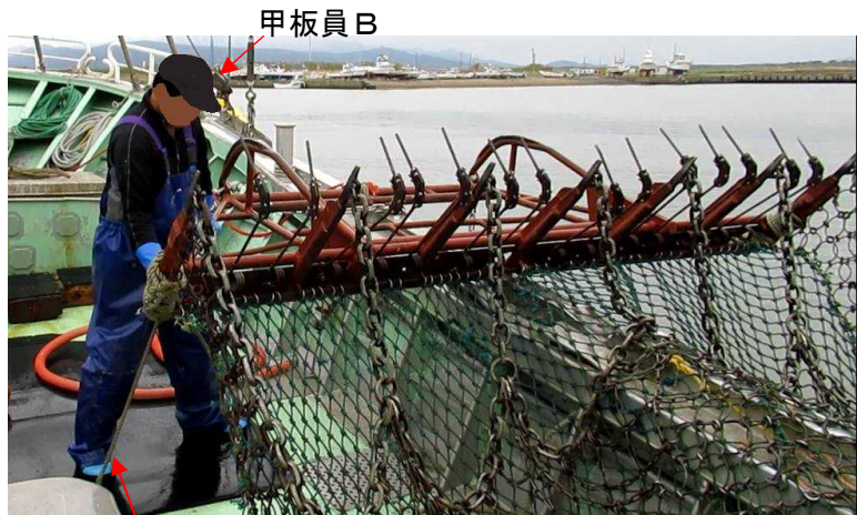
固定用ロープ 写真5 桁投入時の状況（再現） （投入時は外す）
