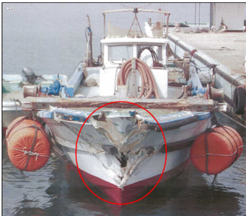
写真3 C船の船首から見た損傷状況
