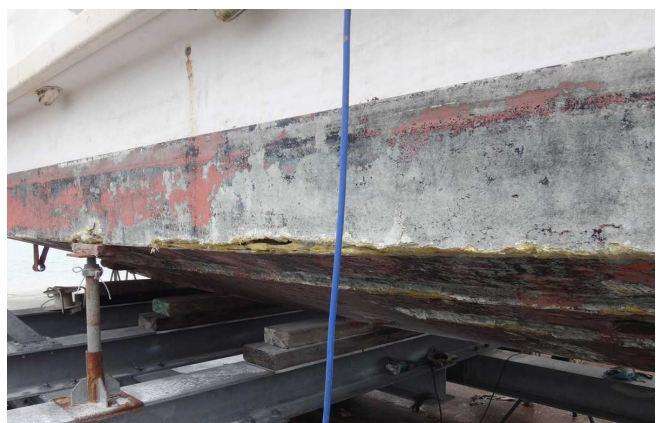
写真2 右舷中央部船底外板の損傷状況
