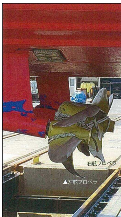
写真2 プロペラ翼の破損等状況
