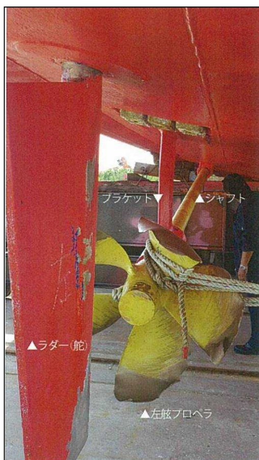
写真2 プロペラ翼の破損等状況
