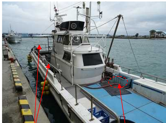
ハンドレールの増設箇所 引揚げ索があった場所
