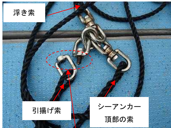
スイベルの破損箇所
