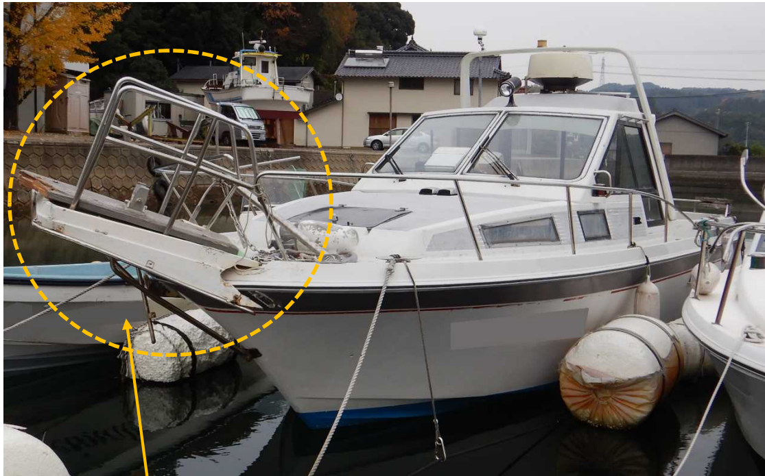
船首部バウスプリットに割損
