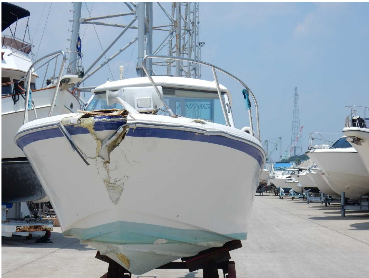
写真1 本船船首部の損傷状況
