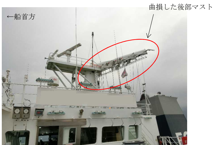
図2 本船の損傷状況
