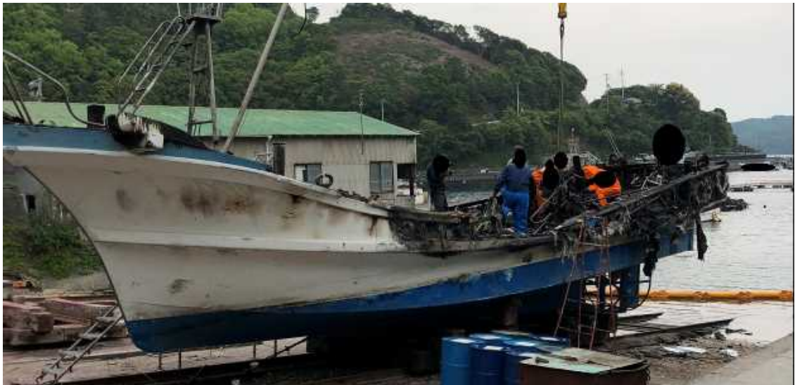
写真2 本船の焼損状況
