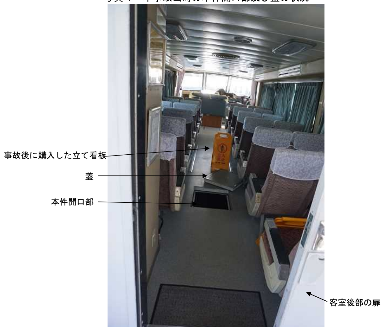
写真4 本事故当時の本件開口部及び蓋の状況
