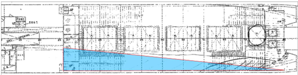
(c) \phi_{\text{Fr.65}} = 17.7\text{deg.} における上甲板および作業甲板上の滞留範囲模式図
