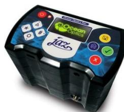
図3 本試験で使用した分光器（Ocean Optics 社 Jaz）の外観
