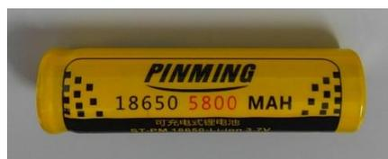
図2 本レーザー製品内蔵のリチウムイオン二次乾電池（18650）
