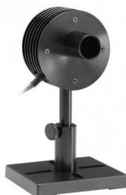
図5 本試験で使用したパワーメータ（Ophir 社 12A-V1）の外観
