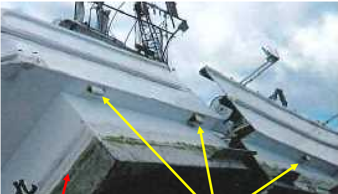
写真4 甲板からの排水口
