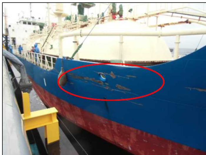
写真1 本船右舷船首部の損傷状況
