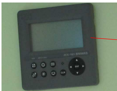
写真3 船橋航海当直警報装置操作表示器
