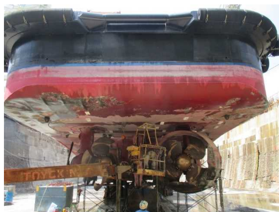
写真2 船尾部の損傷状況
