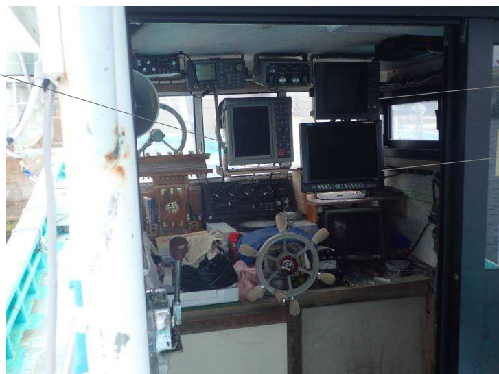
写真3 操船していた場所から見たGPSプロッター等の状況
