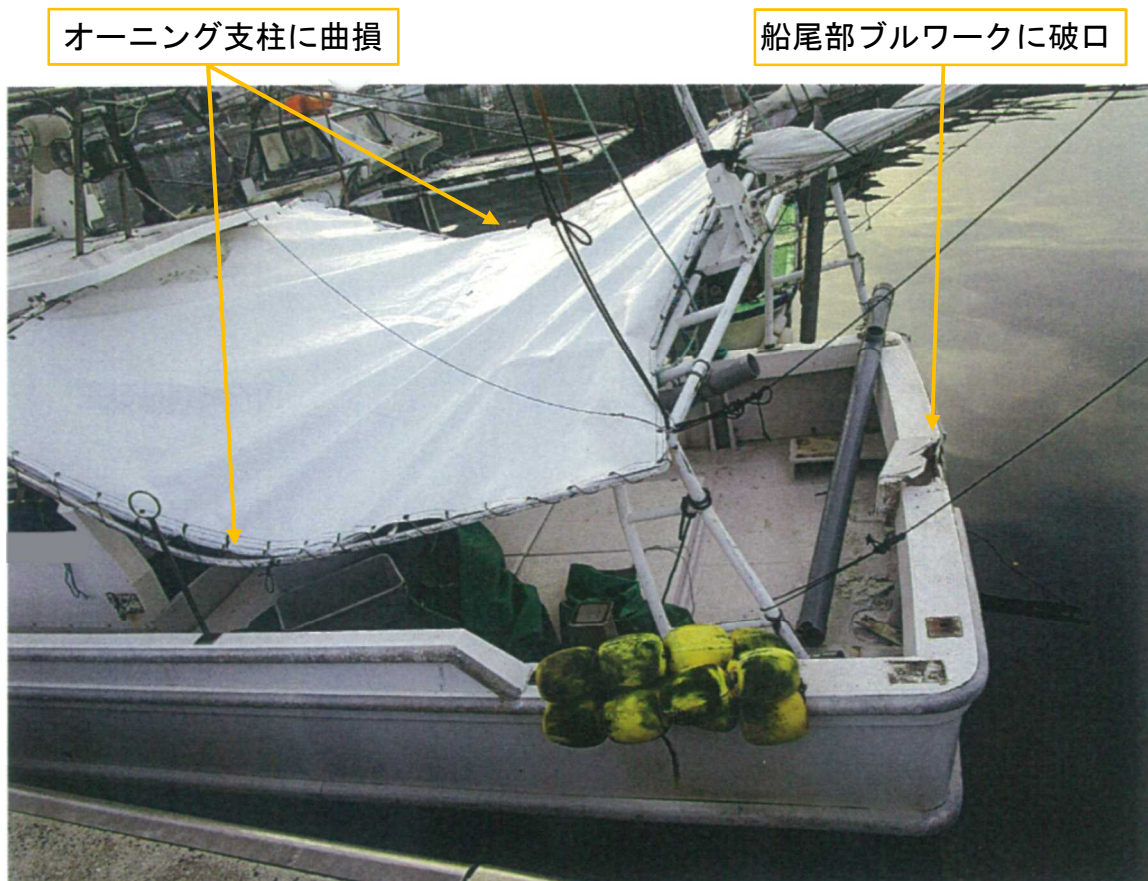
写真2 A船船尾部の損傷状況
