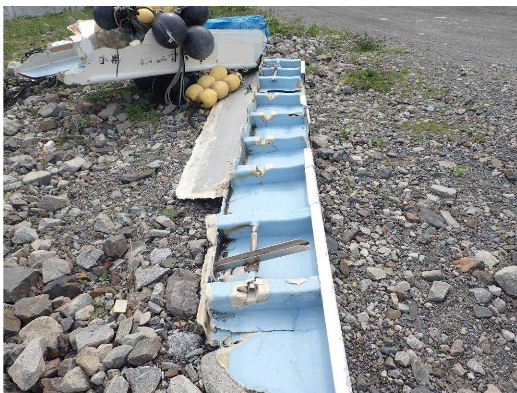
写真4 本船船体損傷状況（左舷ブルワーク）
