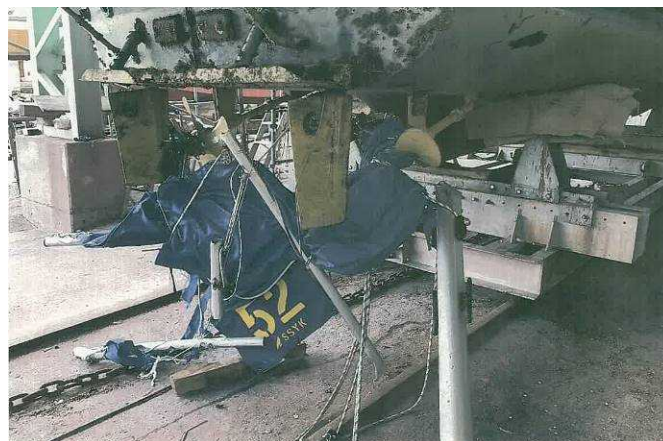
写真5 B船のプロペラ翼及びA船の船尾部スパンカーの損傷状況
