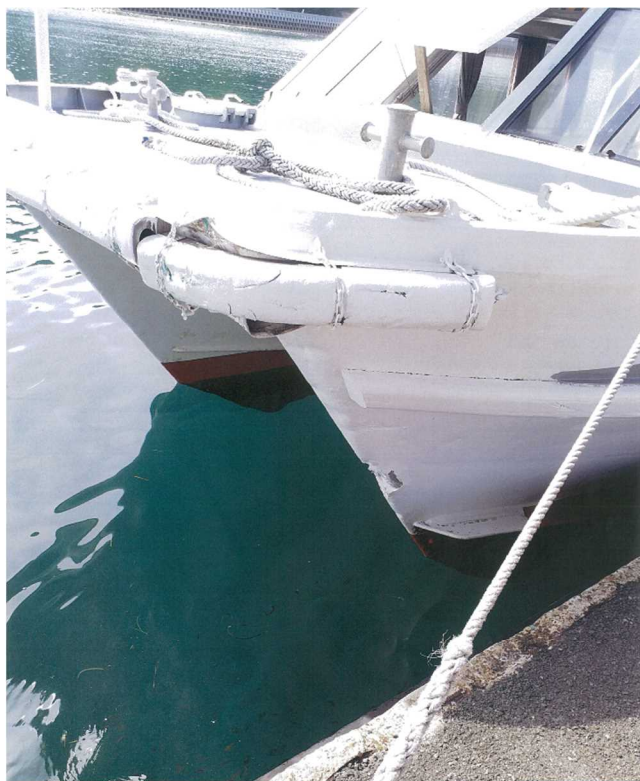
写真1 本船の損傷状況（左舷船首部）
